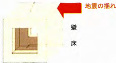
「面」で構成されるツーバイフォー工法の壁
